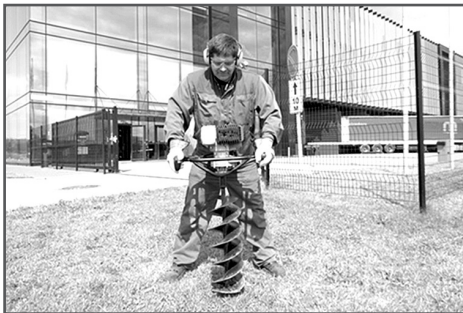
Рис. 8 Положение тела оператора при работе мотобуром
