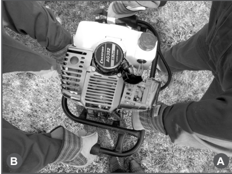
Рис.10 Положение рук при работе вдвоем
