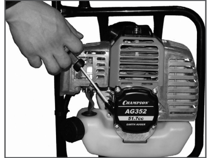
Рис. 7 Свободный ход шнура стартера
