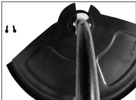
Рис. 3 Установка защитного кожуха
