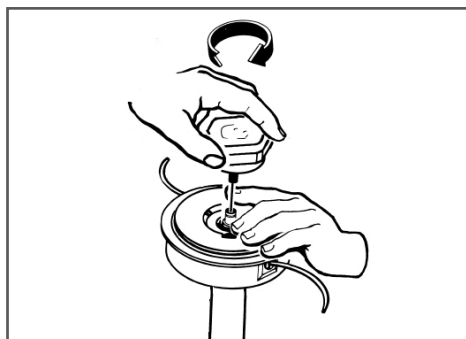
Рис. 14 Закручивание гайки крепления триммерной головки
